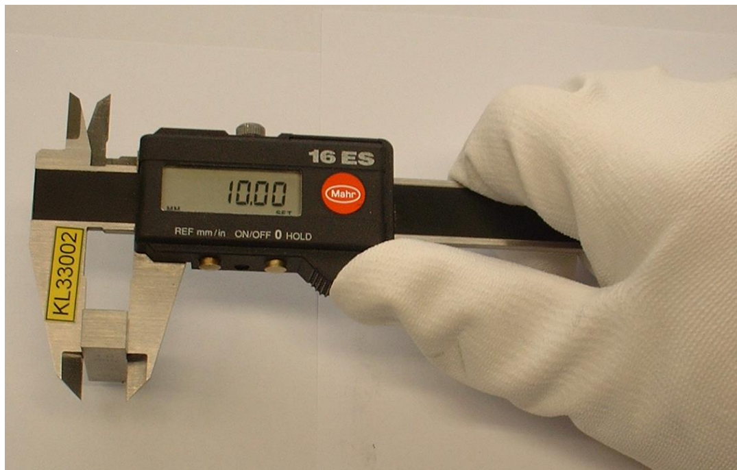
Bild L.IV.1 Kalibrierung eines Messschiebers
