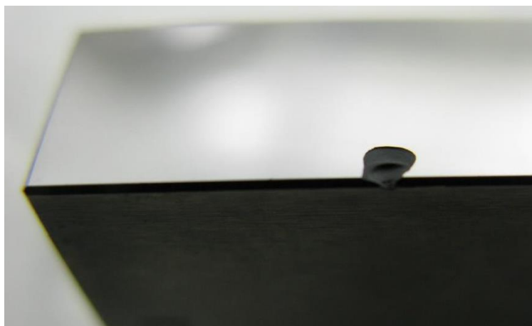
Beispielhafte Absplitterung auf der Messfläche eines Endmaßes
