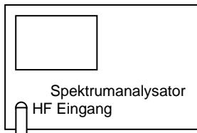
Bild XIII.5.9.1 Kalibrierung des Eigenrauschens eines Spektrumanalysators mit 50 Ohm Lastabschluss am HF-Eingang
