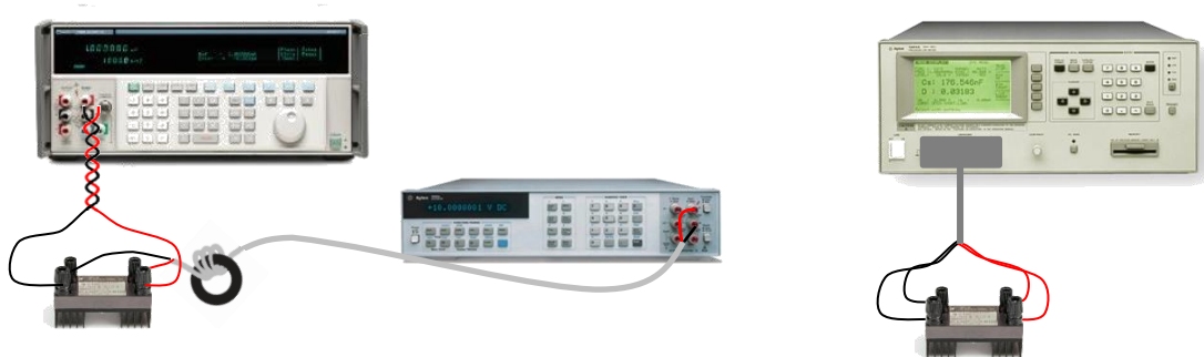
Bild XI.2.3.1 Messmethoden der AC-Widerstandskalibrierung
