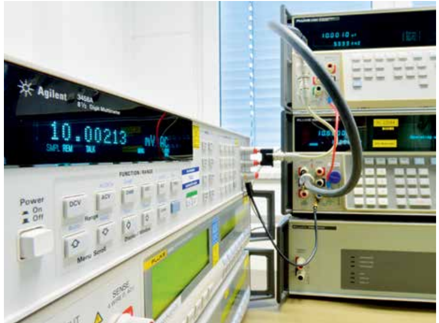
Bild 1. Hochgenaue AC/DC-Transferkalibrierung von Wechselspannung
