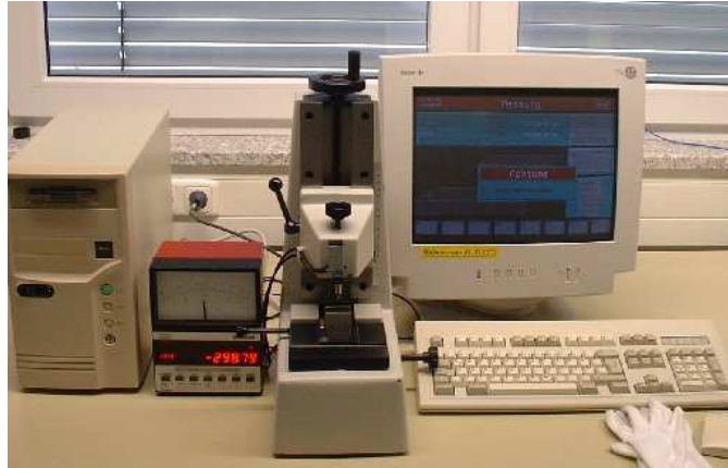
Bild VI.1 Kalibrierung am Endmaßmessgerät
