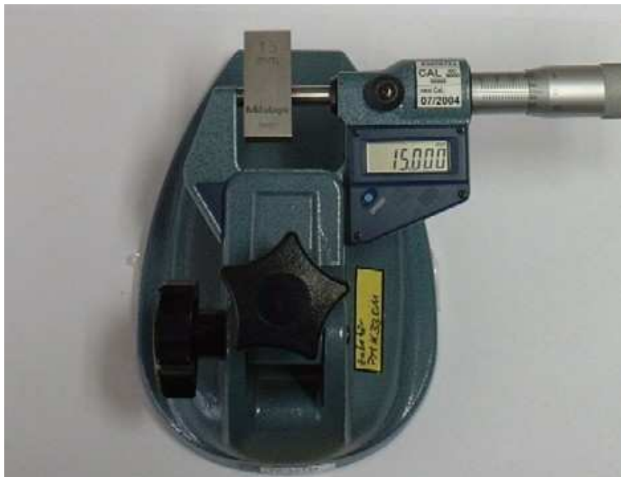
Bild V.1 Kalibrierung einer Bügelmessschraube
