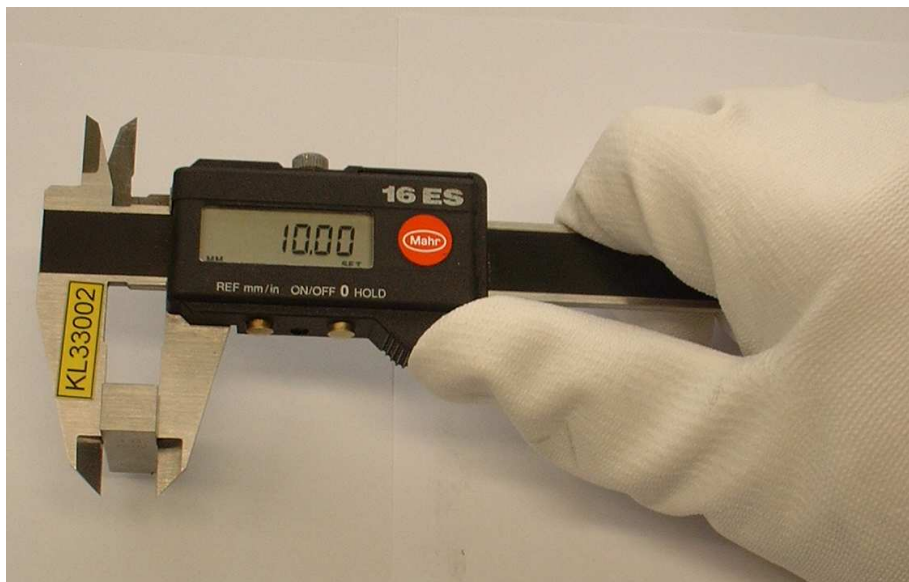
Bild IV.1 Kalibrierung eines Messschiebers
