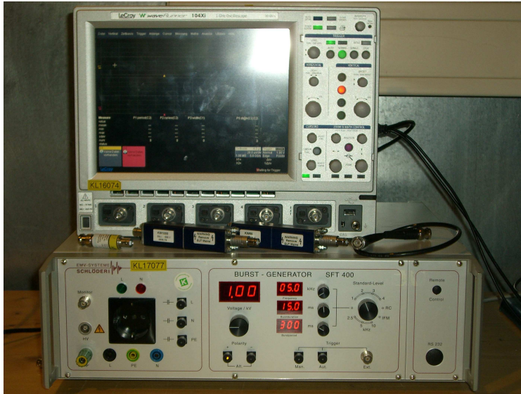
typischer Burstgenerator (links unten) und verwendetes Testsystem bestehend aus High-Speed-Oszilloskop, den HV-Teilern EMTest KW50 / KW1000 und BNC-1 GHz-Dämpfungsglied.
