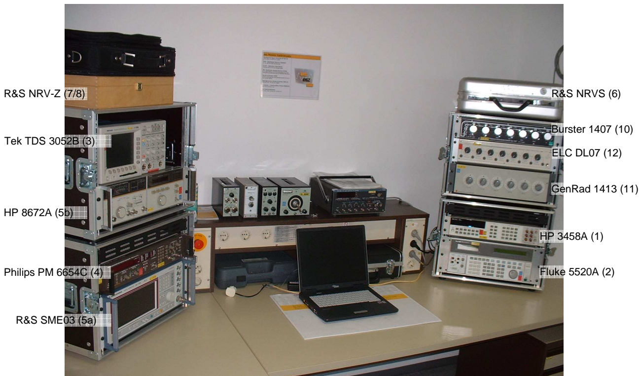
Bild XXII.1 Mobiler Kalibrierplatz im permanenten Labor. Sofern nicht im mobilen Einsatz werden die Geräte als Messplatz im permanenten Labor genutzt. Dadurch wird die dauerhafte Funktion des Equipments garantiert.
