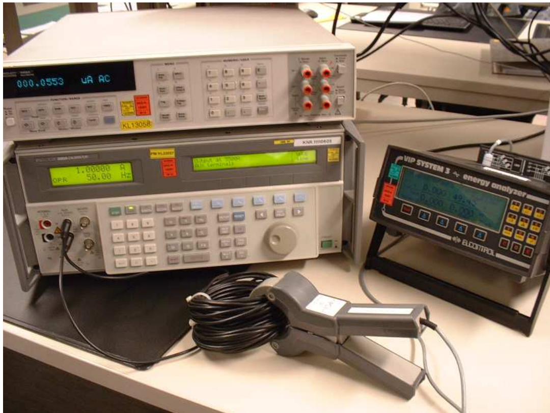
Stromzangenkalibrierung an 50-facher Leitungswicklung
