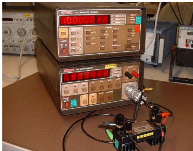
Bild XV.2 - Millivoltkalibrierung an Stromquelle Keithley 263: An der Quelle eingestellt sind 10 \mu A an 100,0019 \Omega . Mit dem korrigierten Wert aus dem Kalibrierschein (9,99884 \mu A) ergibt sich rechnerisch eine Spannung 0,999902 mV. Das eigene Nanovoltmeter zeigt 0,99997 mV. Die Ergebnisse dieser Vergleichsmessungen werden als Reproduktionsauswertungen im Messunsicherheitsbudget berücksichtigt.
