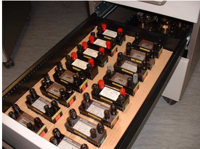
Bild XV.1 Festwiderstände Burster 1240. Anschluss in 4-Draht Technik
