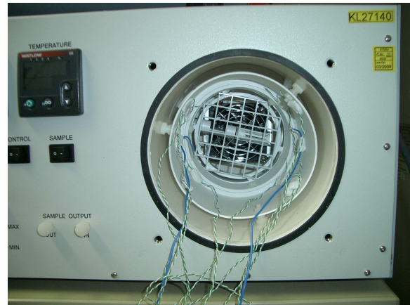
Bild XVI.5.2b Messfühleranordnung zur Inhomogenitätsmessung im Innenvolumen
