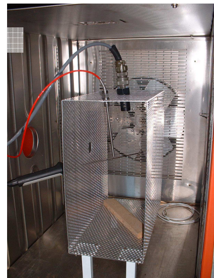
Temperaturen >60 °C bzw. große Messobjekte werden im Drahtkäfig kalibriert
