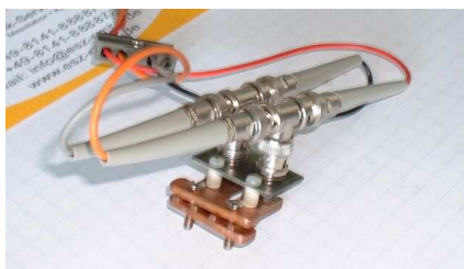
Bild XII.3b Kurzschluss an Messschuh
