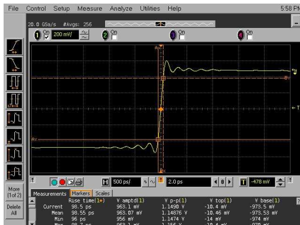
Bild IX.4.2.2 optimale Darstellung am Bildschirm. Base- und Topline sind „gut“ eingeschungen.
