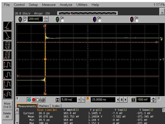
Bild IX.3.3.1a „Einmessen“ des Oszilloskops mit dem 65,8ps Puls und Bestimmung von t_{System}=74 ps
