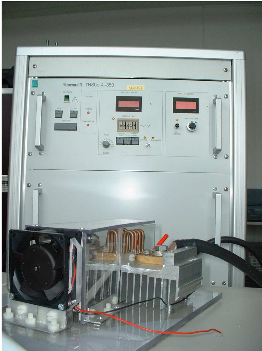
Bild VII.2 Kalibrierung von Hochlastwiderständen durch Spannungsmessung
